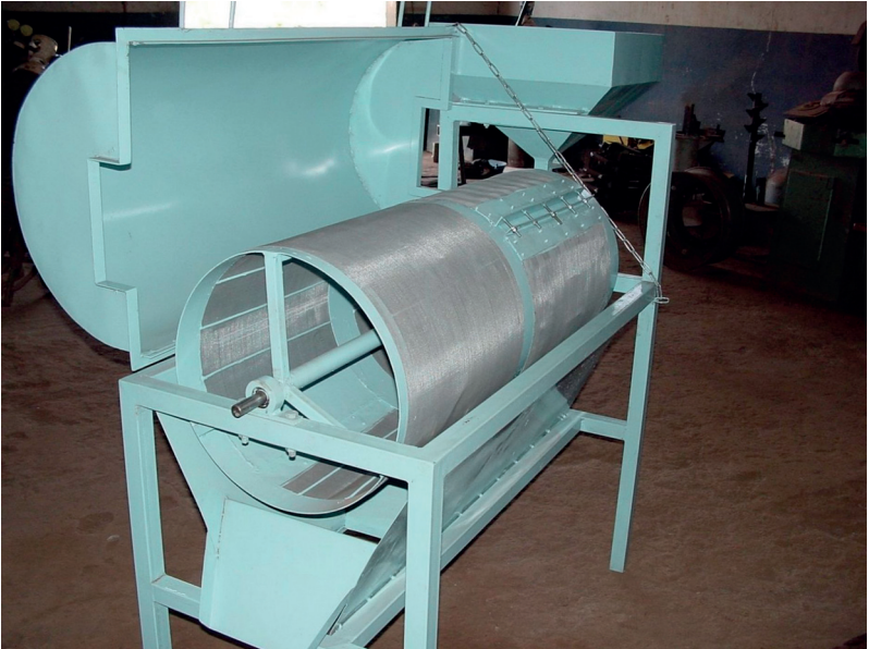
Crible rotatif conçu pour le nettoyage du fonio (© M. Rivier).
