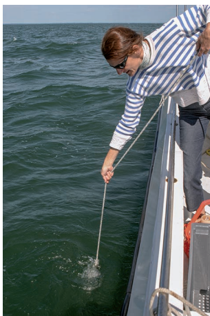
Photos 9 et 10. Prélèvement d'eau. À gauche : mise à l'eau de la bouteille armée pour le prélèvement. À droite : récupération de la bouteille après le prélèvement.
