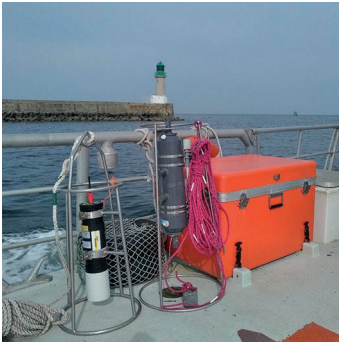
Photos 17 et 18. À gauche : sonde multiparamètres et bouteille à prélèvement pour des prélèvements Rephy sur le bateau de la Société nationale de sauvetage en mer du Croisic. À droite : analyse de nutriments au laboratoire Ifremer de Nantes.
