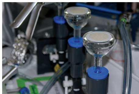
Photos 15 et 16. Filtration de la chlorophylle a . À gauche : chaîne de filtration. À droite : chlorophylle a sur les filtres.
