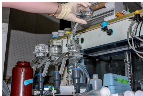
Photos 15 et 16. Filtration de la chlorophylle a . À gauche : chaîne de filtration. À droite : chlorophylle a sur les filtres.
