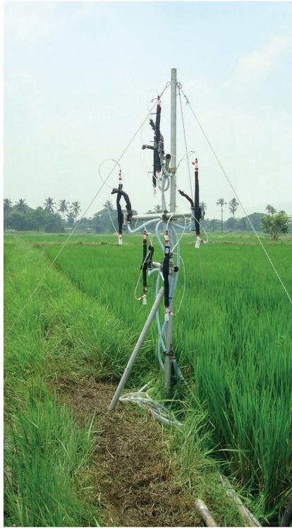
**Figure 4.2.B.** Photo des denuders lors d'une expérimentation réalisée en Inde en 2017 (© Céline Décuq).
