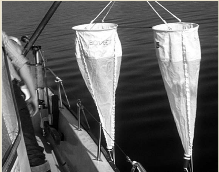
Filets jumelés permettant de capturer simultanément le phytoplancton et le zooplancton dans la même colonne d’eau. Balvay G., 2010. Archorales Inra , tome 14, p. 200.
