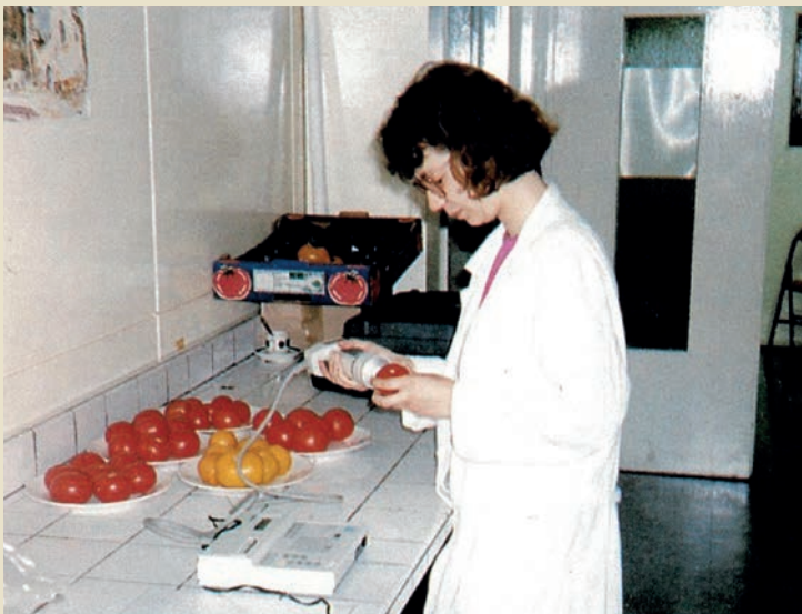
Mesure colorimétrique de tomates. Centre Inra de Dijon. INRA mensuel , n° 68, avril 1993, p. 36.
