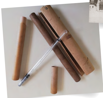
■ Thermomètres à renversement ayant appartenu à Jean Furnestin, utilisés pour mesurer, de manière fiable, la température de l'eau de mer à différentes profondeurs, fabrication Negretti & Zamba, Londres, n° de série S.14.540 et S.14.541, de 2 °C à 25 °C, 1928.
