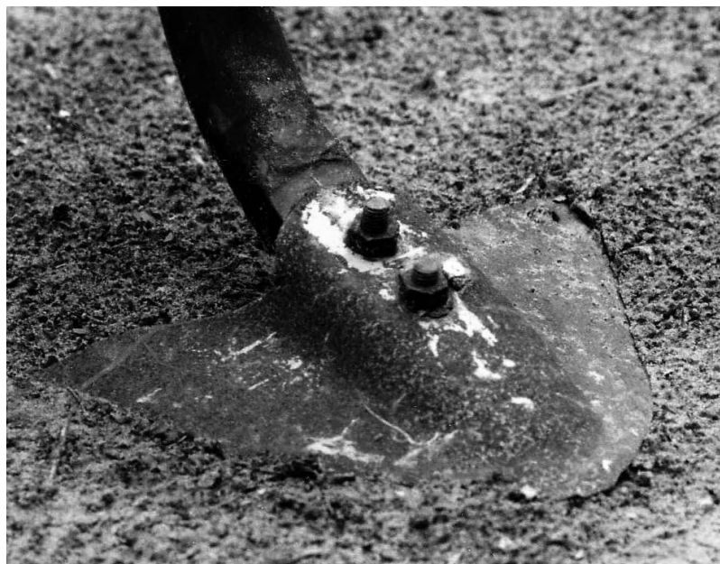
Photo 9.1. Modèle de lame souleveuse de fabrication artisanale en vente sur un marché hebdomadaire au Sénégal (photo M. Havard).
