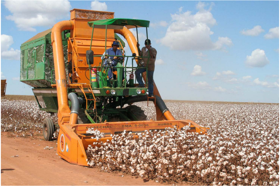
Figure 6. Récolte mécanique du coton-graine avec la machine stripper dans le cas de semis à haute densité (rangs serrés) (Brésil, Mato Grosso, octobre 2009)
