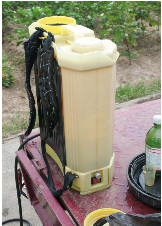
Figure 92. Appareil de pulvérisation à dos électrique ; la batterie est dans la partie basale (Chine, Hubei, août 2015)
