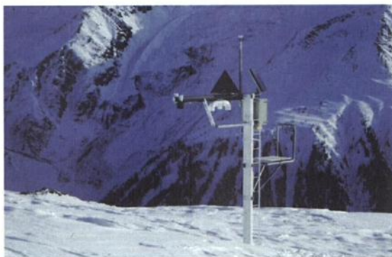
Station automatique “nivôse”. La hauteur de neige, la température et la vitesse du vent sont mesurées toutes les heures et sont transmises via satellite.
