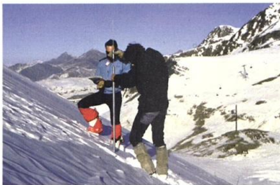
Le sondage par battage, complété par le profil stratigraphique, permet de repérer les zones de faible résistance dans le manteau neigeux.
