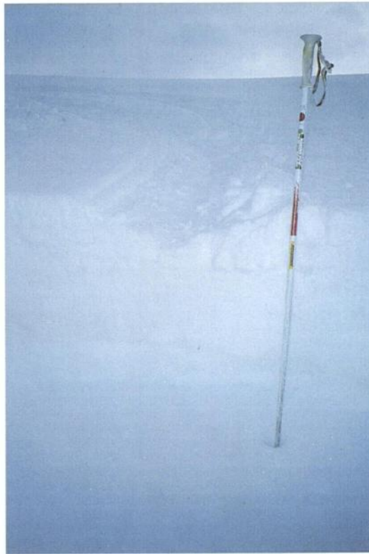
Couche de neige récente (on y enfonce le poing) sur couche de neige plus compacte (on y enfonce 4 doigts) sur couche de neige tendre (on y passe la main) : situation typiquement instable. Cliché A. Duclos.
