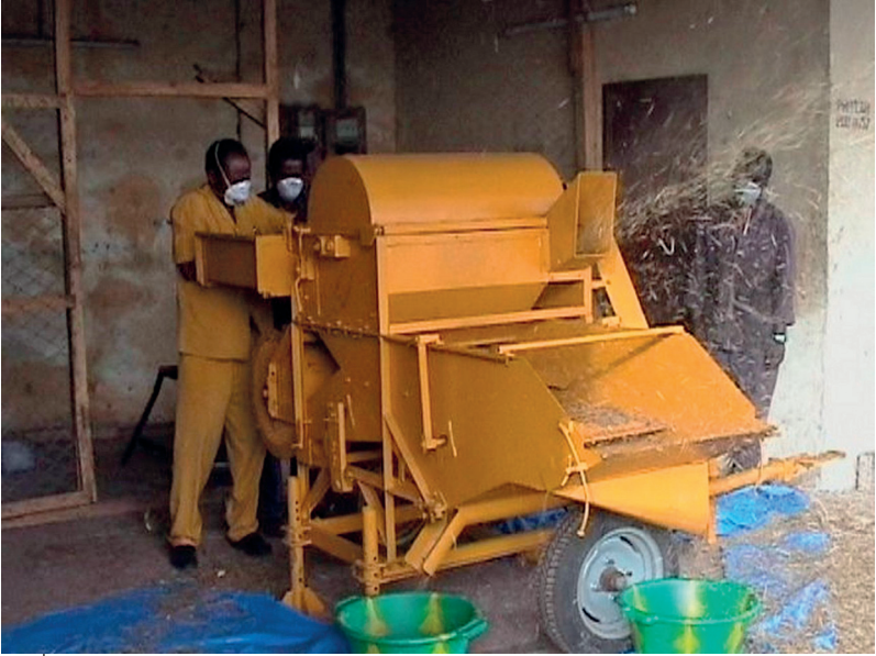
Batteuse Assi modifiée pour le battage mécanique du fonio (© J.-F. Cruz).
