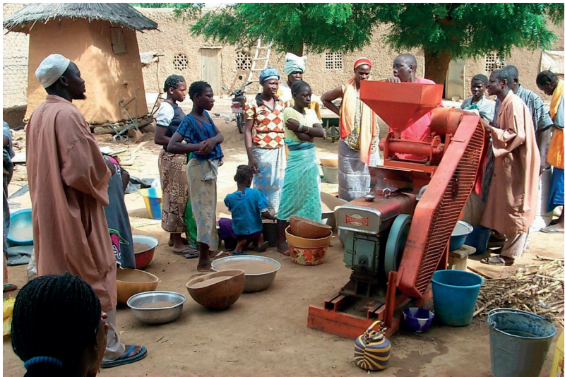
Démonstration du décortiqueur à fonio GMBF dans un village du Mali (© D. Dramé).
