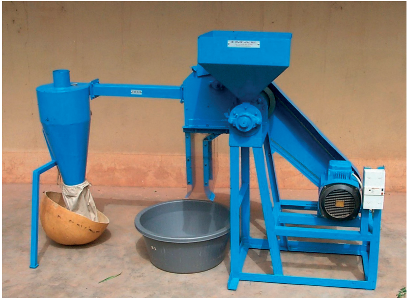
Décortiqueur à fonio GMBF avec moteur électrique (© D. Dramé).
