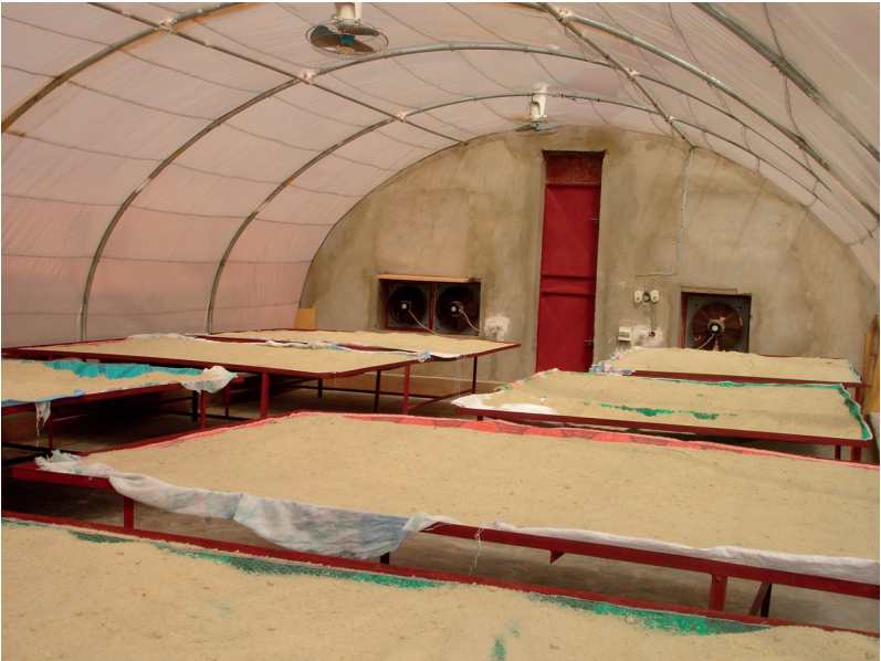
Séchoir serre CSec-S pour le séchage solaire du fonio précuit (© J.-F. Cruz).
